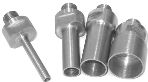
Рисунок 5 – Пассивные рабочие инструменты для размерной обработки отверстий диаметром от 3 до 15 мм
