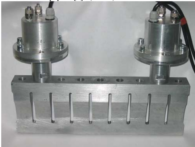
Рис.2. Ультразвуковая колебательная система для обеспечения сварного шва длиной 360мм.
