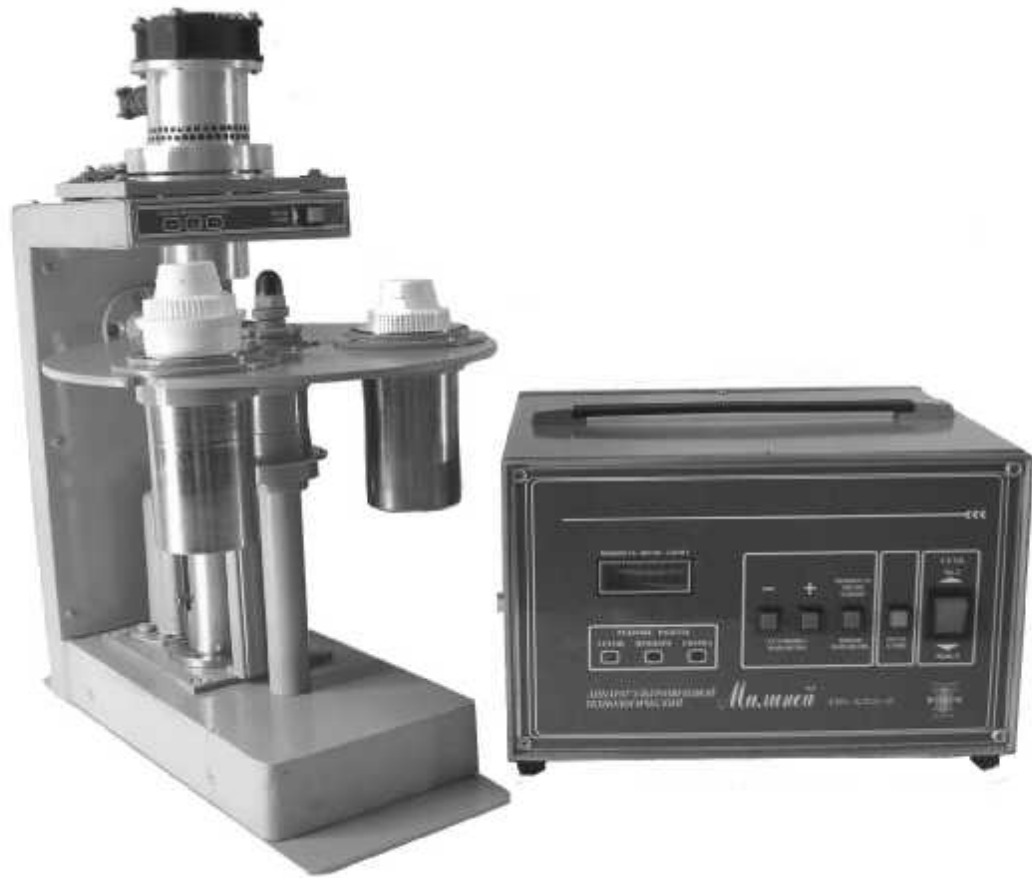
Рисунок 6 Установка сварки элементов картриджа.
