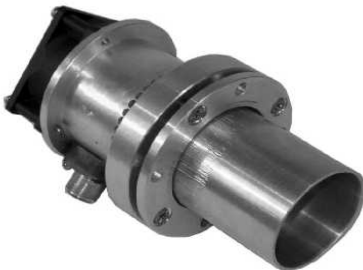
Рисунок 5 Ультразвуковая колебательная система.
