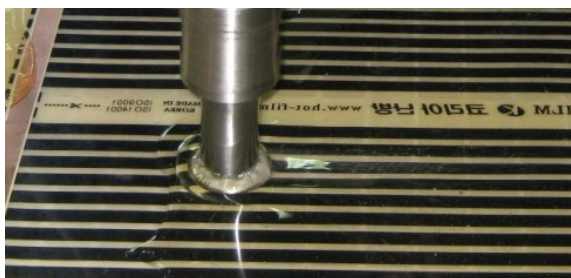
Рис. 5. Воздействие на слой эпоксидной смолы, нанесенной на поверхность нагревательного элемента
