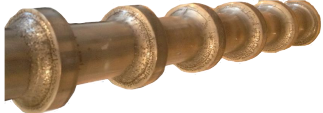
Рис.4. Неравномерный кавитационный износ излучателя
