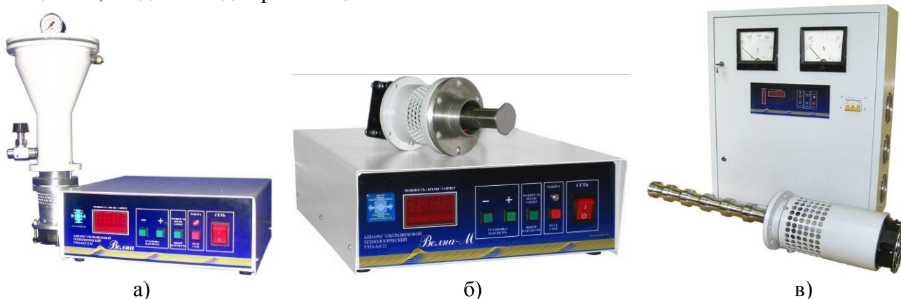
Рисунок 1 – Ультразвуковые аппараты, реализующие получение конструкционных наноматериалов: (а) из химических растворов; (б) в кавитирующих средах; (в) промышленное кавитационное диспергирование
