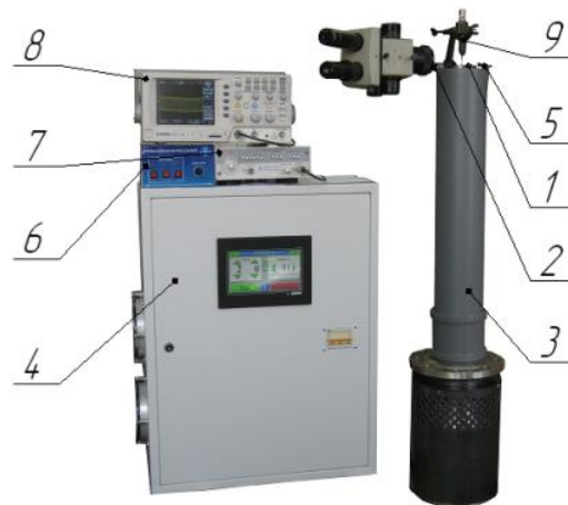
Рисунок 5 – Измерительный стенд, где 1 – ультразвуковая колебательная система, 2 – микроскоп, 3 – технологический объём, 4 - ультразвуковой генератор, 5 – стробоскопическая система освещения, 6 - электронный генератор импульсов, 7 – генератор образцовой частоты, 8 – осциллограф, 9 – измерительный щуп
