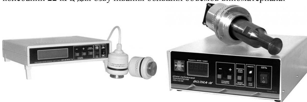
Рисунок 1 – Ультразвуковые аппараты для обработки жидких сред: «Нежность» (слева) и «Волна-М» (справа)
