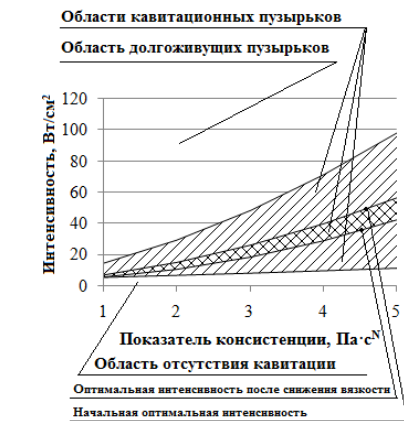
а) для псевдопластических жидкостей (показатель нелинейности N = -0,1)
