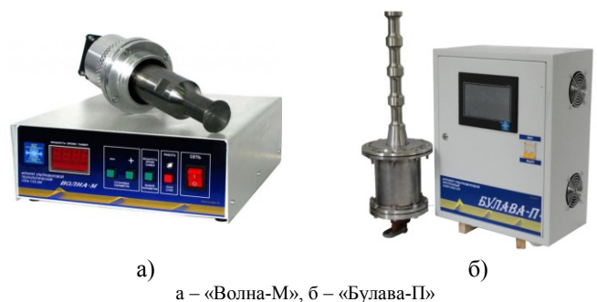
Рис. 1. Исследуемое ультразвуковое технологическое оборудование
