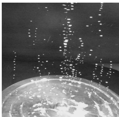
Рисунок 2 – Коагуляция наночастиц в стоячей волне
