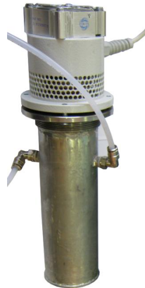
Рис. 5. Модернизированный излучатель ультразвукового аппарата «Волна-М»
