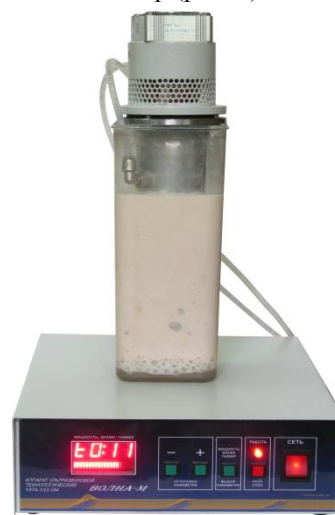
Рис. 6. Обработка эмульсии модернизированным ультразвуковым аппаратом «Волна-М»
