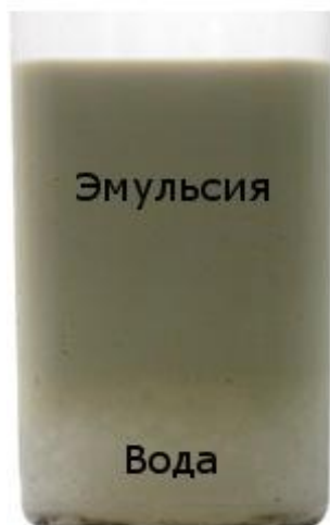
Рис. 7. Результат эксперимента с модернизированным ультразвуковым аппаратом «Волна-М»
