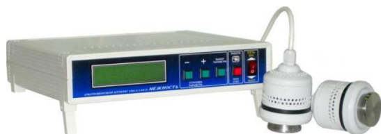
Рис. 2. Ультразвуковой лабораторный аппарат «Нежность» для обработки жидких сред
