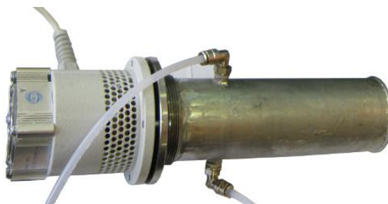
Рис. 2 – Модернизированный излучатель ультразвукового аппарата «Волна-М»
