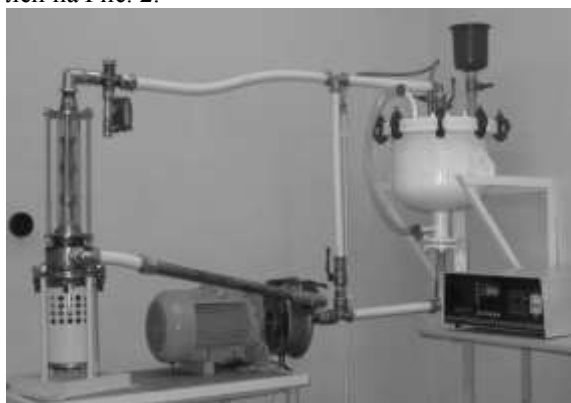
Рис. 2. Общий вид лабораторного стенда для проточной кавитационной обработки жидких сред
