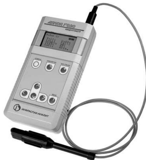
Рис. 3. Портативный кондуктометр «АНИОН-7020» (ООО НПП «Инфраспек-Аналит»)
