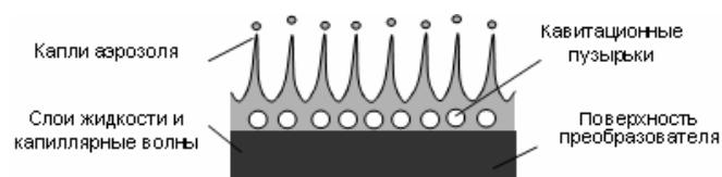
Рис. 1 Механизм образования капель аэрозоля
