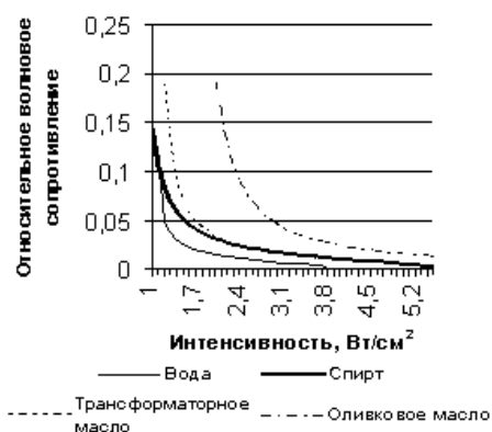
Рис. 3. Зависимость относительного волнового сопротивления от интенсивности воздействия для различных типов жидкостей
