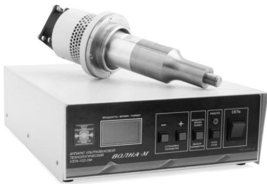
Рис. 3. Внешний вид ультразвукового технологического оборудования с демонтированной фильерой
