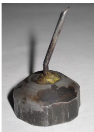
Рисунок 8.20 – Разрушение выхлопной трубки
