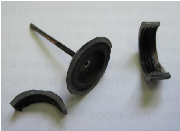
Рисунок 8.19 – Разрушение распылительной камеры
