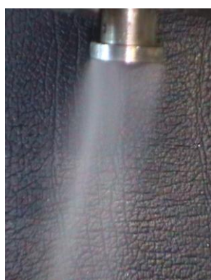
Рисунок 8.3 – Изменение формы факела распыления при движении ультразвуковой колебательной системы
