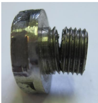
Рисунок 8.18 – Разрушение распылительной камеры № 1
